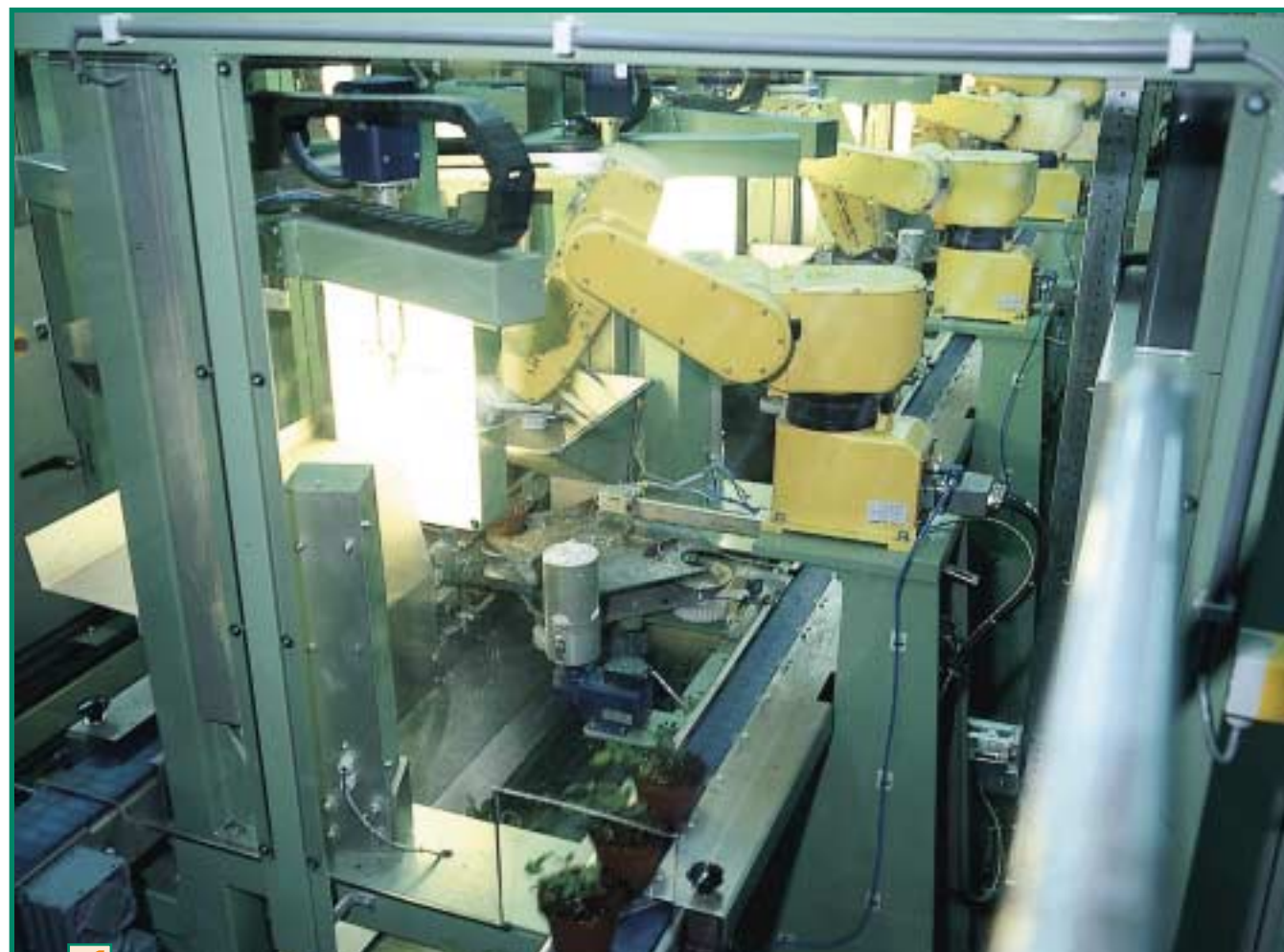
1 Bij potrozenbedrijf Rombouts in het Brabantse Hapert staat een opstelling van drie lijnen met ieder vier robots. Deze geven een enorme arbeidsbesparing. Jaarlijks maakt het bedrijf 40 miljoen stekken, waaraan nauwelijks meer mensenhanden te pas komen.
