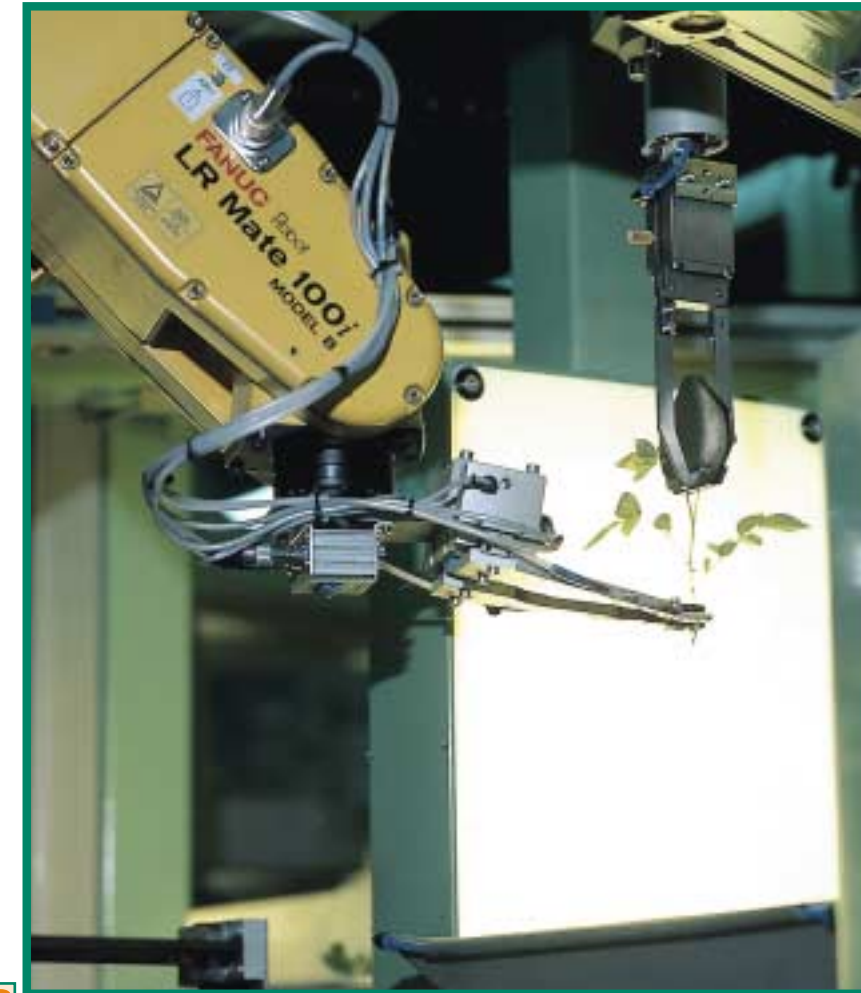
3 Zodra het computersysteem de informatie heeft hoe een rozentak eruit ziet, gaat het knipmechanisme op de robotarm aan de gang. Opgegeven kwaliteitscriteria bepalen hoeveel stekken er uit een tak gaan. Voor een goede beworteling worden de stekken daarna even in groeihormonen gedoopt.
